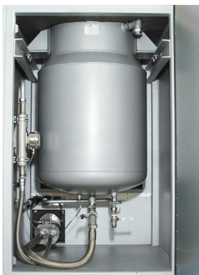
500-Liter-Arbeitsbehälter der ELASTOLINE F 500 liters Work tank of the ELASTOLINE F
